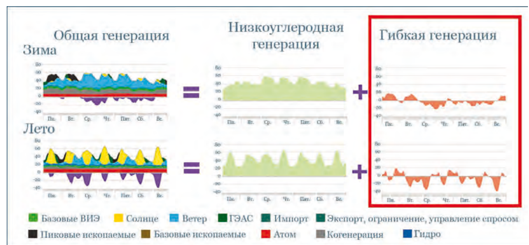
Рисунок 28 Суточные профили энергосистем с высокой долей ВИЭ
