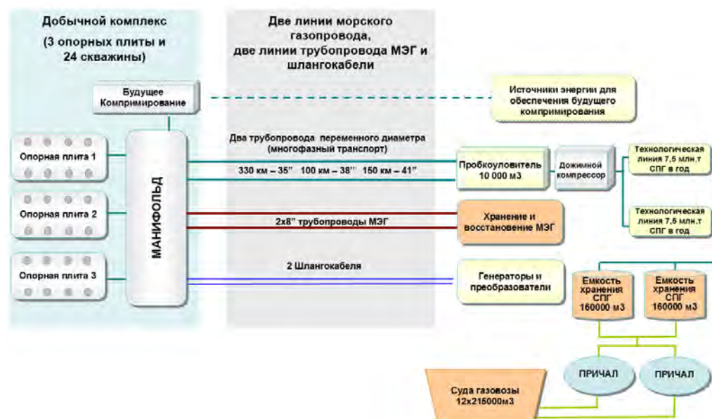
Рисунок 2: Техническая концепция освоения Штокмановского ГКМ (первая фаза)
